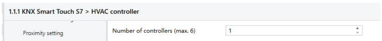
Fig.5.3 “HVAC controller” parameter window
